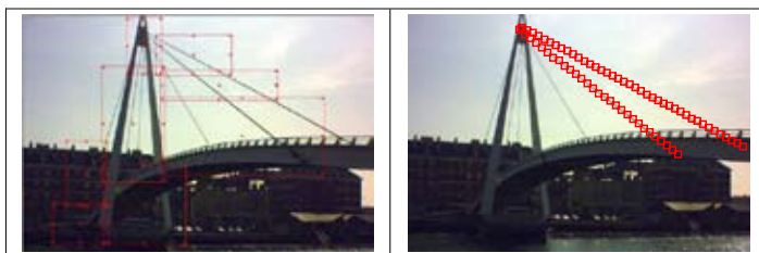
Figure 4 : A gauche : Zones définies avec le contrôleur Optech – A droite : zones définies avec le module développé
