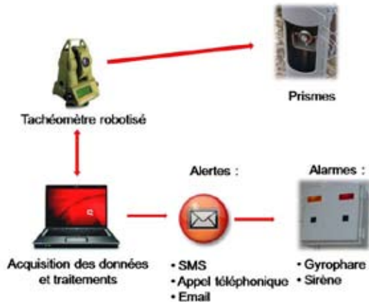
Figure 1 : Principe de la télésurveillance
