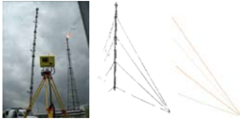
Figure 6 : Torçhère concernée, nuage de points résultant de l'acquisition et haubans modélisés
